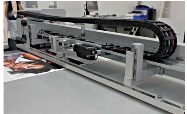
Materiaal-vacuümaanpersbalk voor Überformat print.
